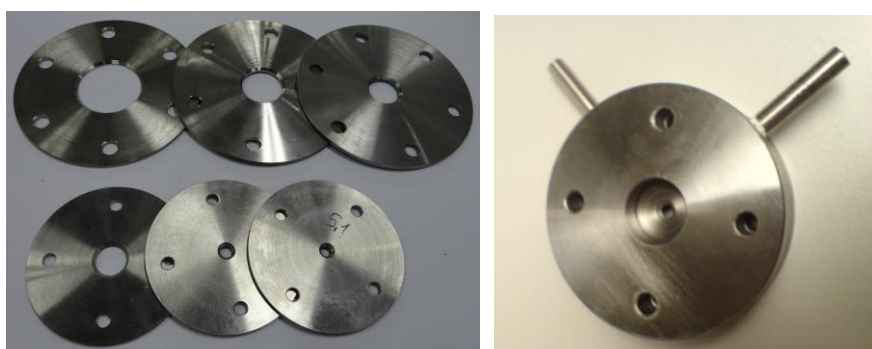
Rys. 1. Kryzy stosowane w testach stanowiska oraz pomiarach, elementy do pomiaru ciśnienia przytarczowego
